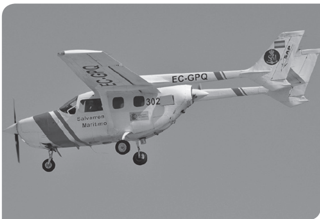
Avioneta Skymaster con dos motores, uno adelante y otro atrás similar a la de la fotografía.
